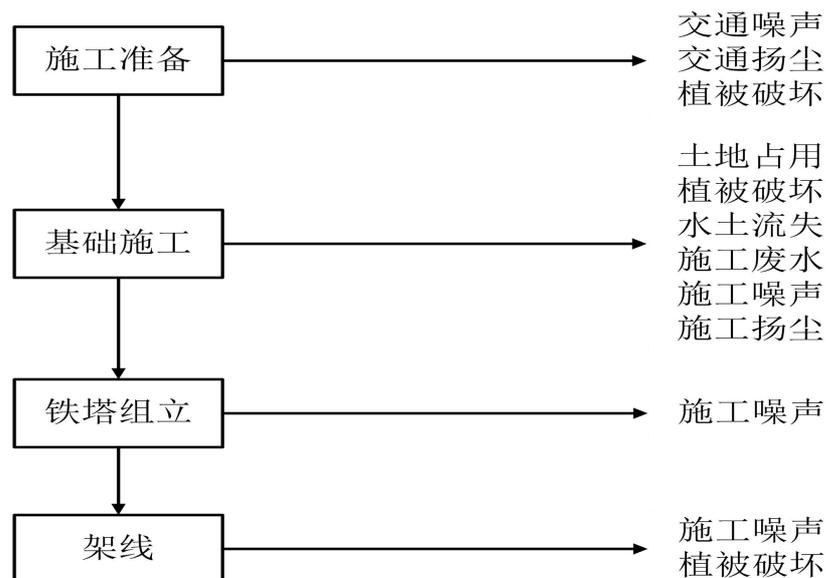
图 2-3 架空线路施工工艺流程及产污环节
