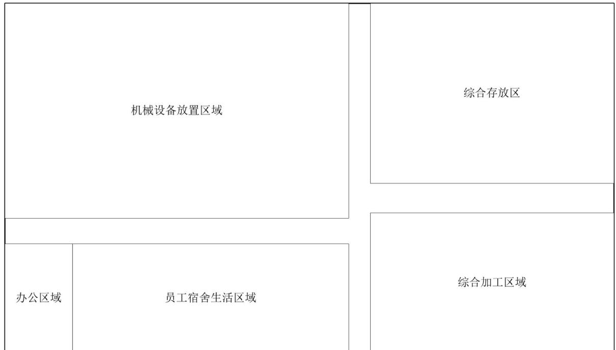
图 2-2 项目依托光伏电场项目临建区平面布置示意图
