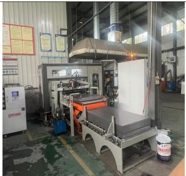
焊接废气处理装置
