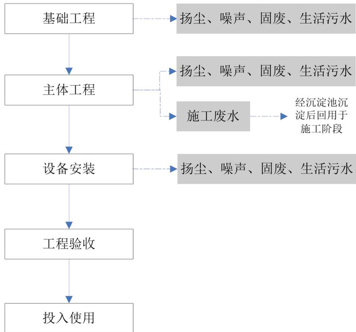
图 2 施工期工艺流程及产污环节图
