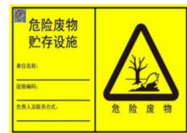
图 5 危废暂存间标识牌
