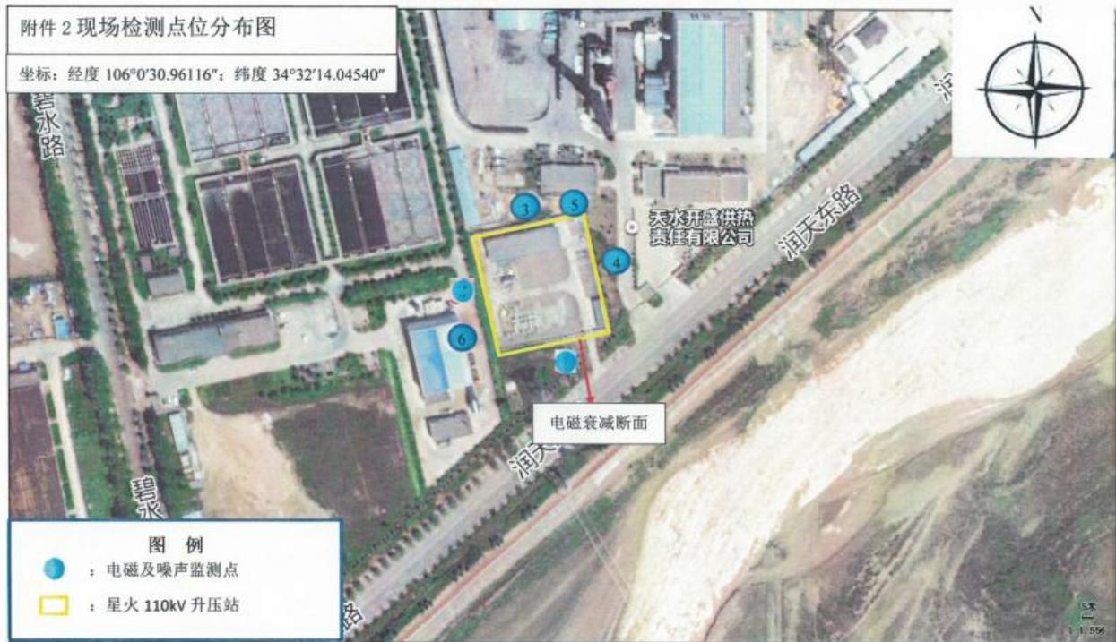
监测结果表明,星火 110 千伏变电站墙外 5m 处工频电场强度为 1.67V/m~277.71V/m, 小于 4kV/m, 磁场强度为 0.28  $\mu$ T~0.68  $\mu$ T, 小于 100  $\mu$ T。均满足《电磁环境控制标准》(GB8702-2014)规定的 4kV/m 工频电场强度验收标准和 100  $\mu$ T 的工频磁场强度验收标准。
