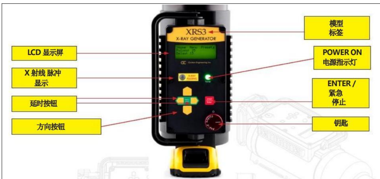
图 9-2 XRS-3 型移动式 X 射线探伤机控制模块示意图
