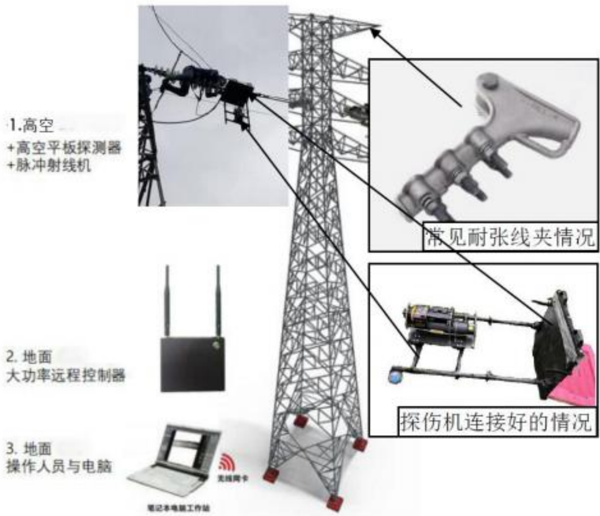
图 9-9 设备组成及使用现场整体框架示意图
