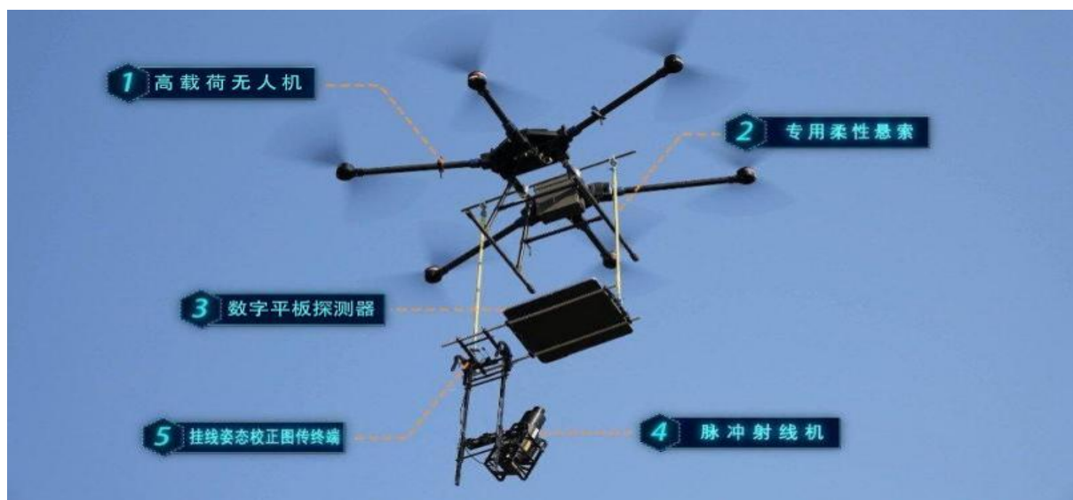
图 9-6 无人机搭载探伤装置示意图
